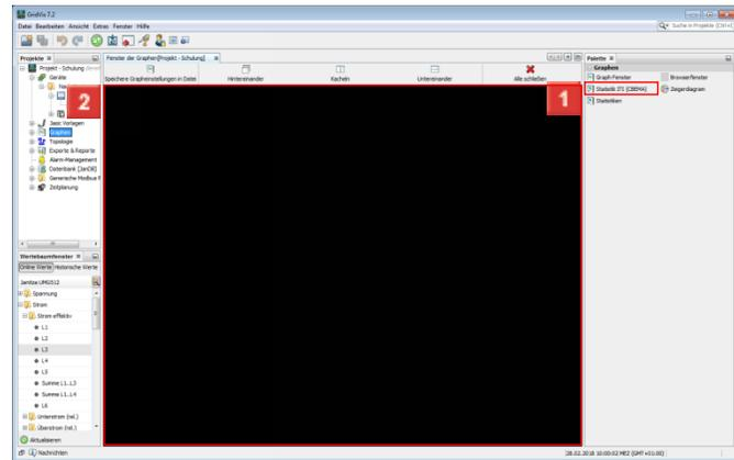
1 Ziehen Sie das Objekt **Statistik ITI (CBEMA)** (
